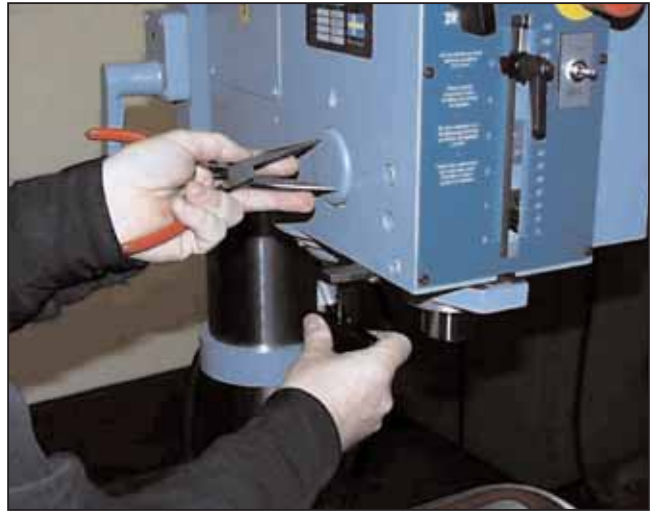
Bild 4. Borttagning av fjäderhus
