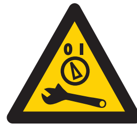
Varning, strömmen måste stängas av vid service och underhåll
